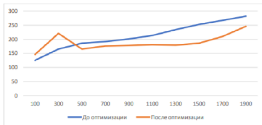
График 1.3 – Максимальное время отклика в миллисекундах от количества запросов в секунду до и после оптимизации
