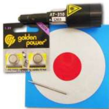
Рисунок 1.3 – Мініатюрна світловідбиваюча мішень в комплекті з лазерною насадкою на робочий макет вогнепальної зброї
