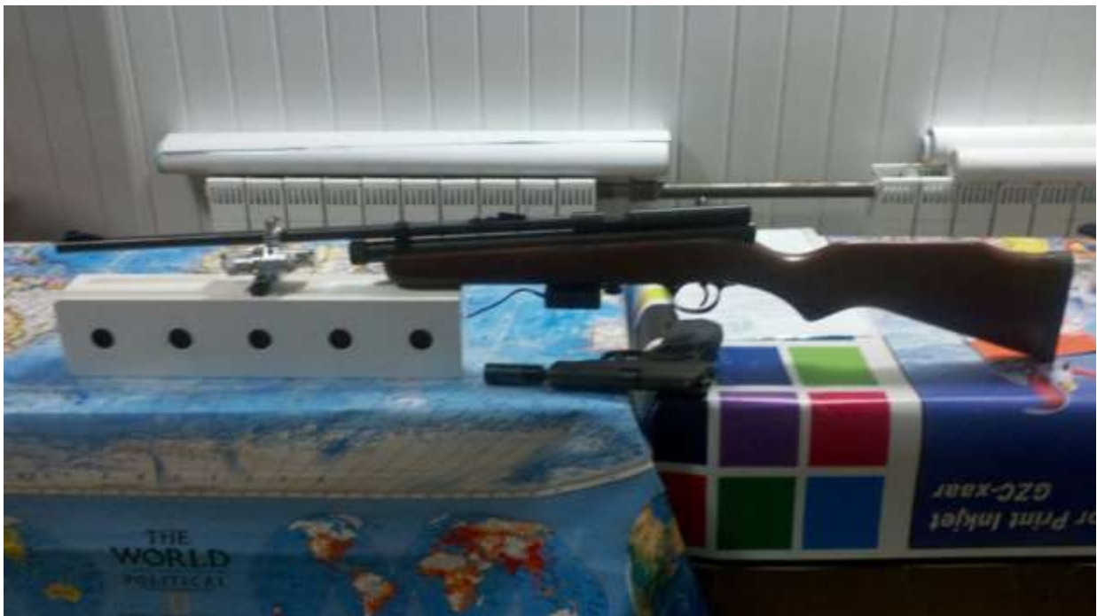
Рисунок 1.5 – Лазерний стрілецький тренажер на основі одного фотоприймача
