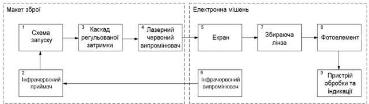
Рисунок 1.6 – Канал прийому стрілецького тренажера на основі одного фотоелемента
