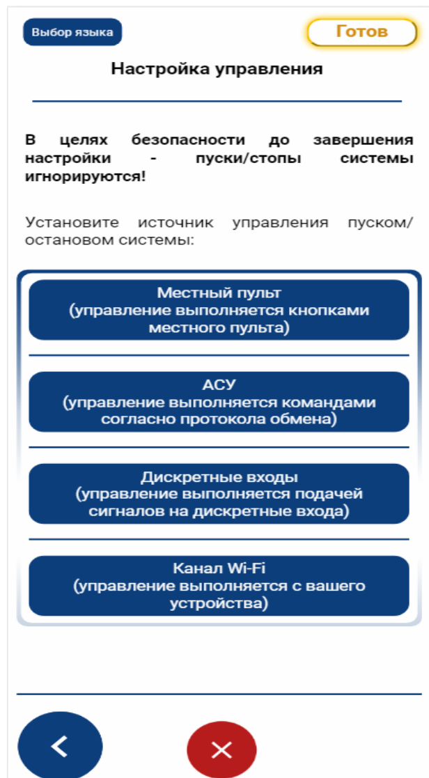
Рисунок 3.15 - Настройка канала управления
