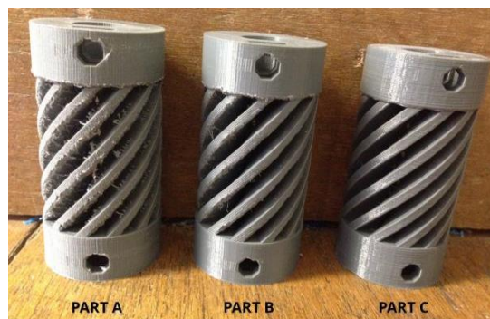
Рисунок 1.11 – Порівняння надрукованих деталей з використанням екранів з різними розмірами пікселя
