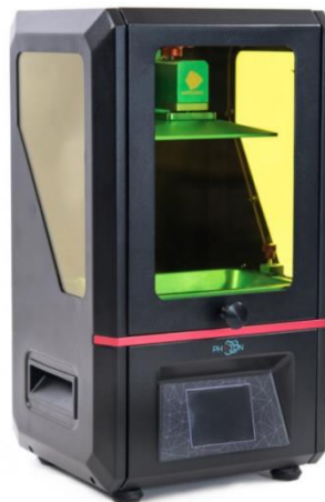
Рисунок 2.16 – Зовнішній вигляд LCD принтеру Anycubic Photon
