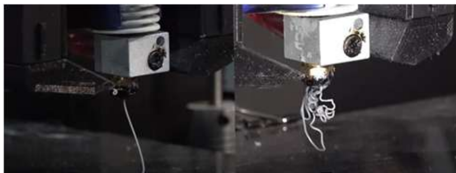
Рисунок 1.13 – Різниця між вологим пластиком і сухим на виході з сопла екструдера
