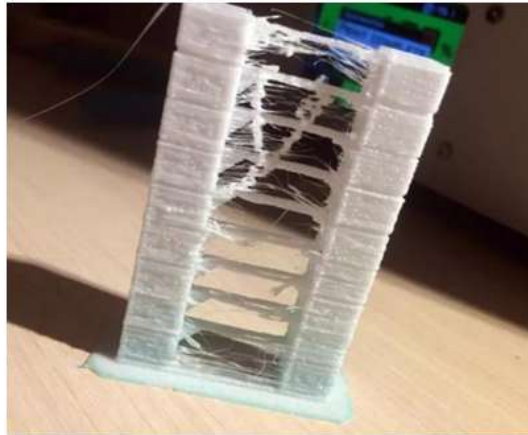
Рисунок 1.12 – Приклад спінювання та утворення пазирів при друкуванні
