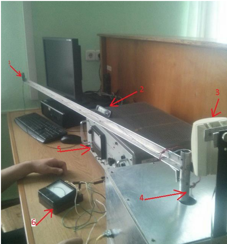
Фото 3.1 – Экспериментальная установка по исследованию характеристик пассивного датчика движения
