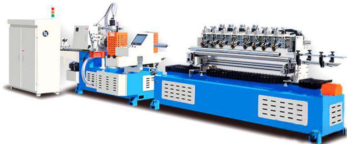
Рисунок 7.1 – Машина для виготовлення картонних втулок
