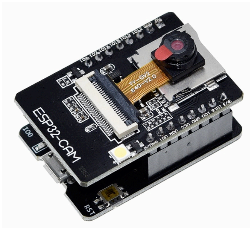
Рисунок 1.2 – Модуль ESP32-CAM (спереду з камерою OV2640) – дешеве рішення для IP-камери з підтримкою Wi-Fi.
