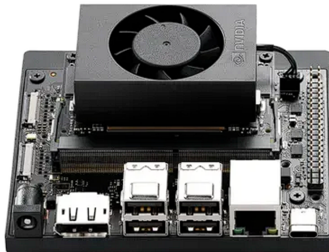
Рисунок 1.4 – NVIDIA Jetson Orin Nano Developer Kit, платформа на основі системи SoC з підтримкою штучного інтелекту
