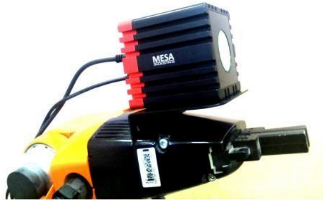
Рисунок 3.2 – Приклад кріплення камери на схват маніпулятора
