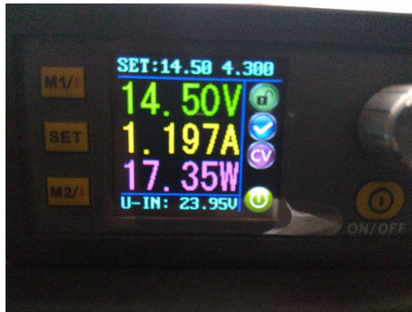
Рисунок 3.4 - Джерело живлення для зарядки акумуляторної батареї
