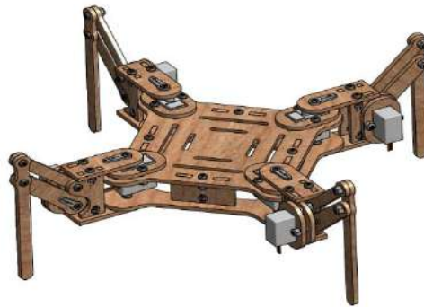
Рис.1 – Чотиринога конструкція крокуючого робота.
