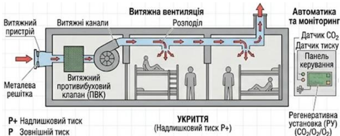
Рисунок 2 – Схема архітектури вентиляції
