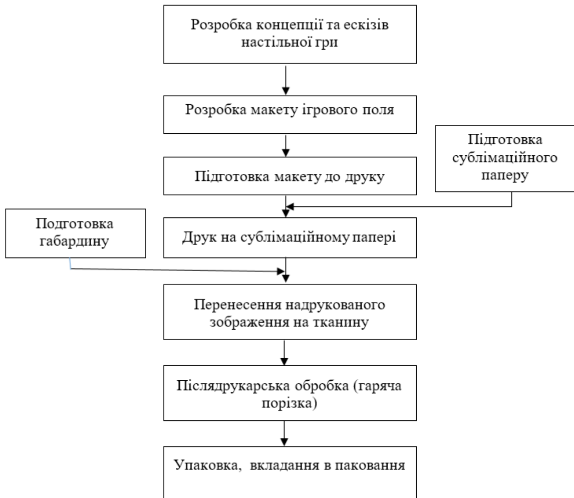
Рисунок 5.4 – Технологічна схема виготовлення ігрового поля за допомогою сублімаційного друку
