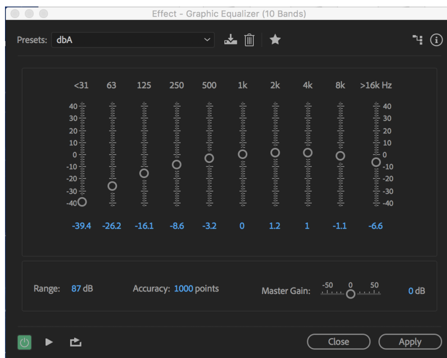
Рисунок 2.10 – Значення АЧХ фільтра типу А
