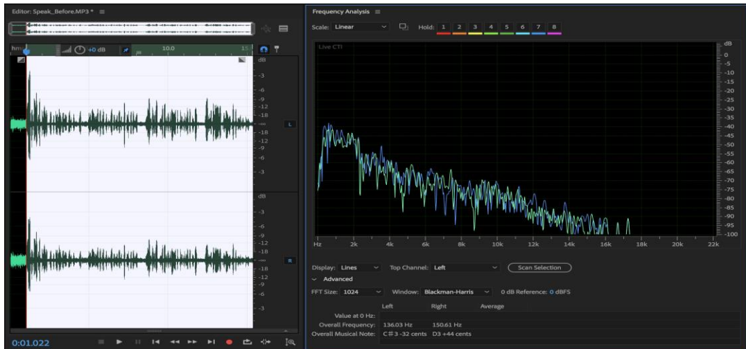
Рисунок 2.18 – АЧХ аудіо запису після застосування фільтра типу А
