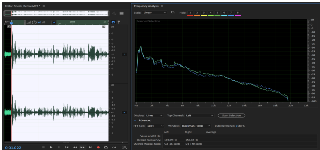
Рисунок 2.19 – Усереднення значень коливань АЧХ протягом виділеної ділянки часу
