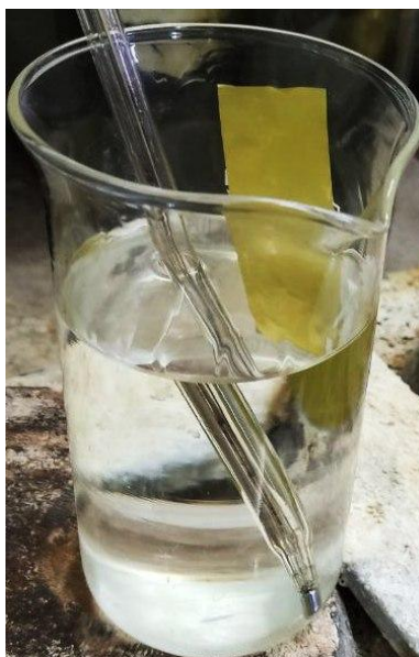
Рисунок 4.1 – Зразок лакового покриття, вертикально занурений у моноетиноламін
