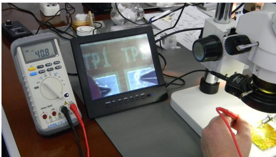
Рисунок 4.5 – Вимірювання електричного опору ланцюгів макета детекторного модуля
