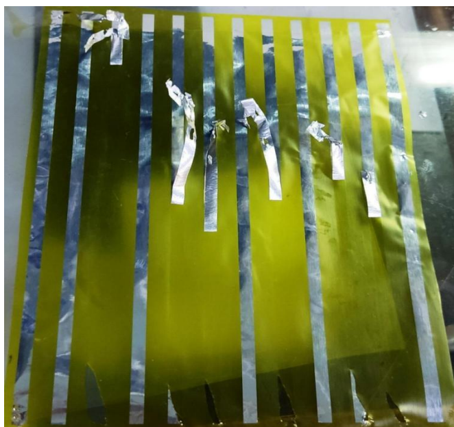
Рисунок 4.2- Вигляд тестової плати для перевірки адгезії після проведення експерименту
