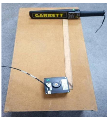
Рисунок 4.8 Установка для вимірювань напруженості електричних і магнітних полів
