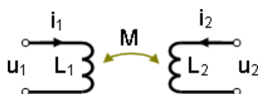
Рисунок 1.3 - Струми взаємоіндукції магнітних полів котушки і металевого об'єкта
