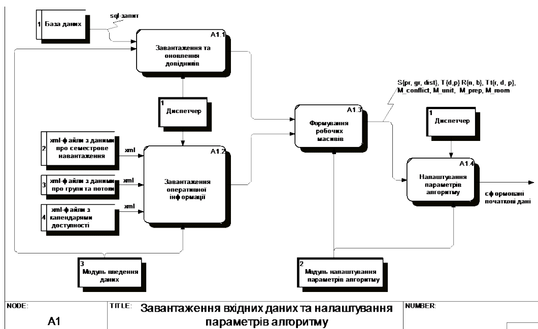
Рисунок 4.10 – Модуль завантаження вхідних даних та налаштування параметрів алгоритму у DFD-нотації
