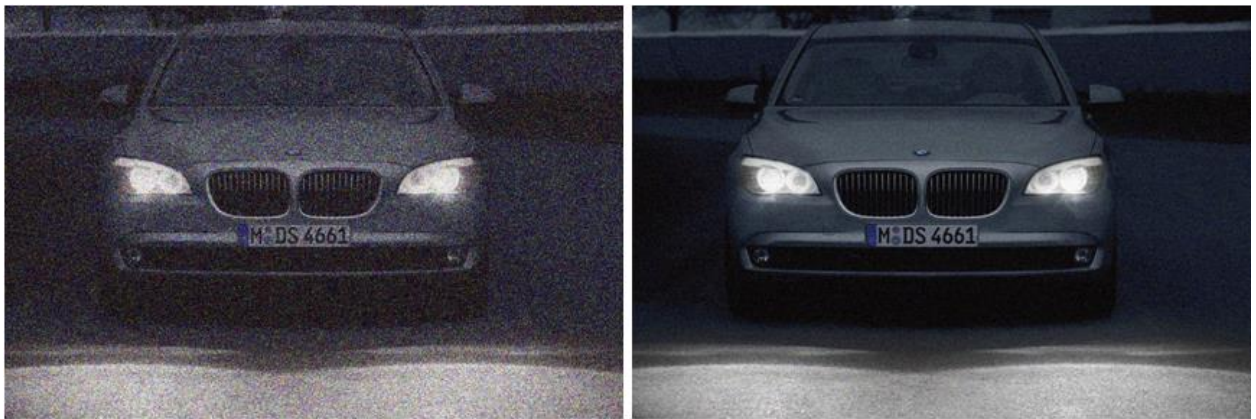
Рисунок 1.7 – Результат роботи DNR фільтру (а) і 3D DNR фільтру (б)
