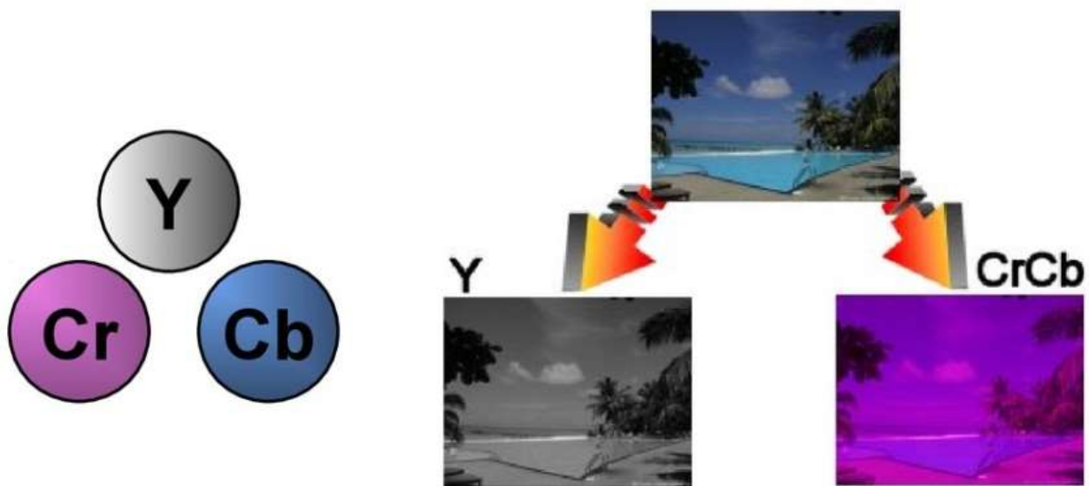
Рисунок 3.2 – Загальний принцип зміни формату колірної опису кадру з композитного RGB до яскравісно-хроматичного YCrCb
