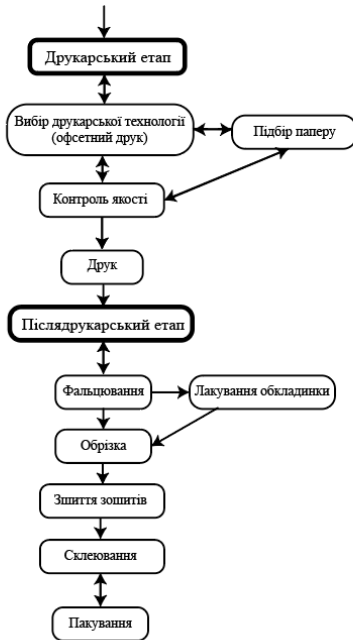
Рисунок 4.2 – Продовження схеми технологічного процесу виготовлення арт-буку
