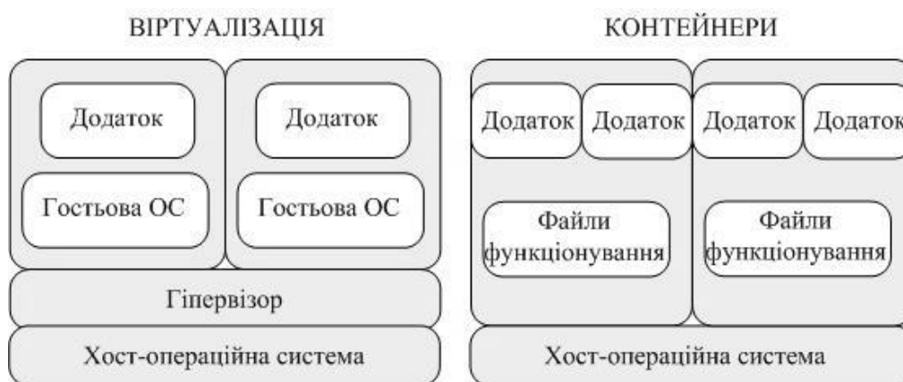
Рис. 5. Графічне порівняння віртуалізації та контейнеризації
