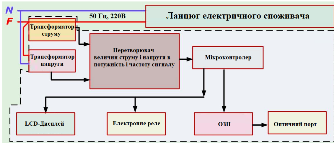
Рисунок 1.9 – Структурна схема електронного однофазного лічильника
