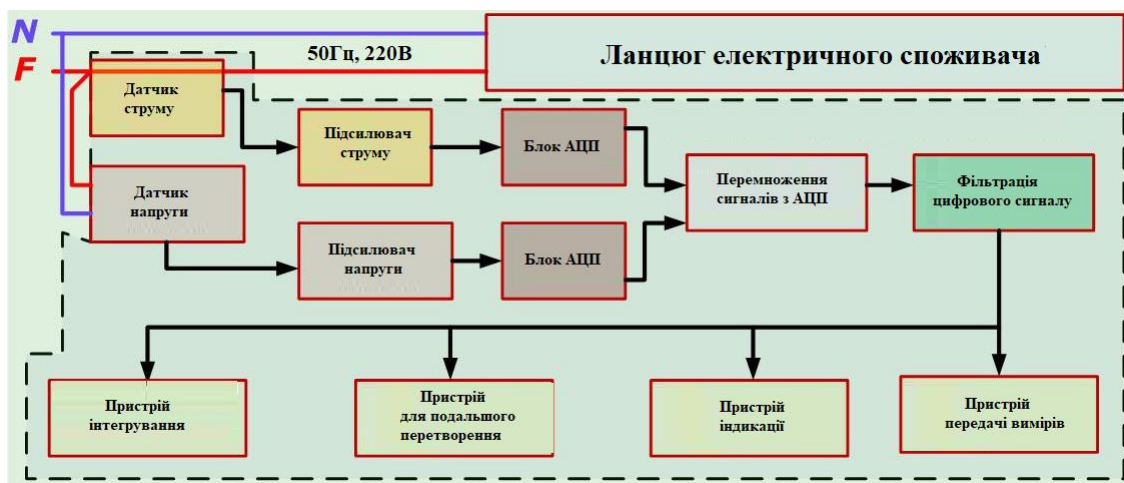
Рисунок 1.8 – Структурна схема електронного лічильника
