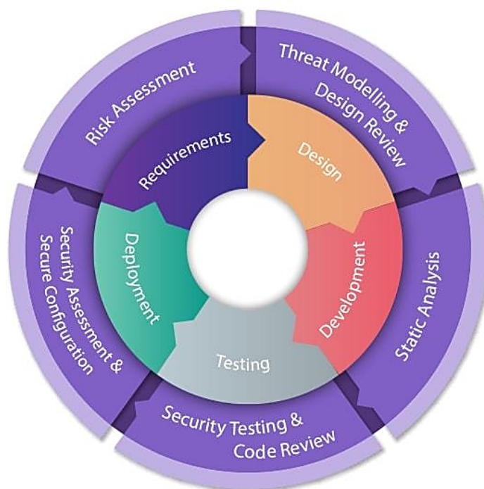
Рисунок 3.2 – Безпечний життєвий цикл розробки програмного забезпечення (SSDLC) [20]
