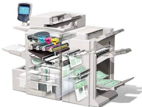
Рисунок 7.1 – Принцип роботи цифрової листової машини
