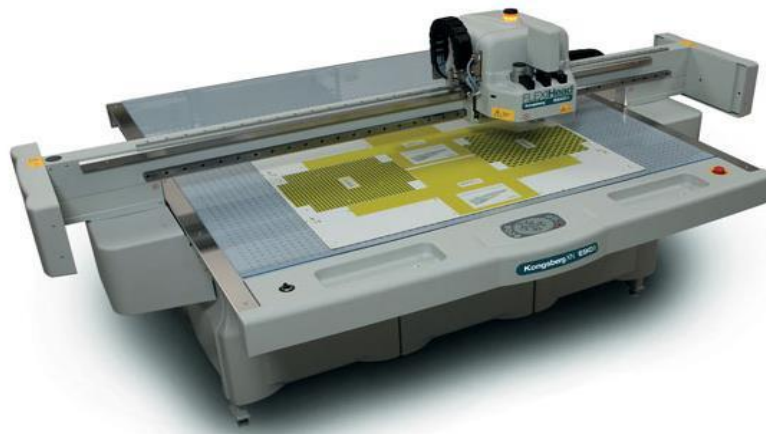
Рисунок 7.4 – Промисловий ріжучий плотер Kongsberg i-XL44
