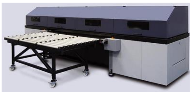
Рисунок 7.2 – DURST Rho 800 Presto – УФ-принтер
