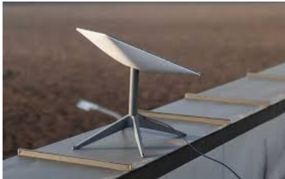
Рисунок 3 – Супутникова антена комплекту Starlink
