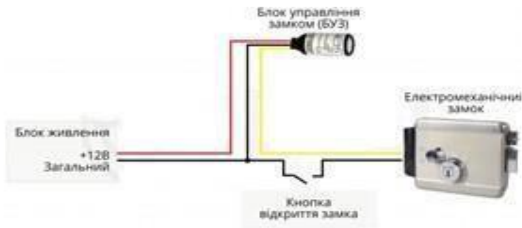
Рисунок 1.3 – Підключення електромеханічного замка за допомогою блоку живлення та пульта дистанційного відкривання дверей
