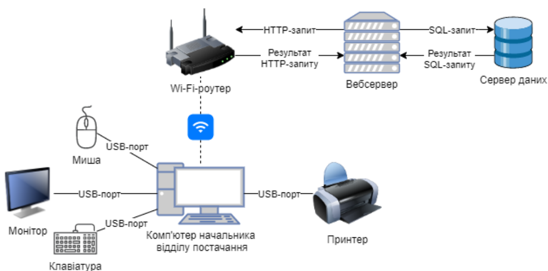
Рисунок 8.1 – Схема КТЗ модуля «Аналіз виконання договорів з постачальниками сировини»
