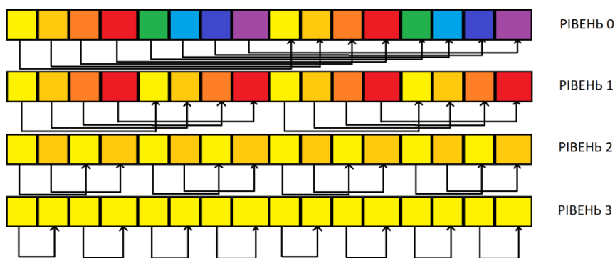
Рис. 2. Представлення взаємодії коефіцієнтів поліномів як взаємодії блоків. Кожен рівень є ітерацією алгоритму швидкого NTT
