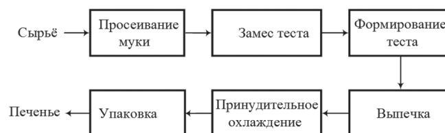
Рис. 1. Обобщенная модель технологического процесса производства печенья
