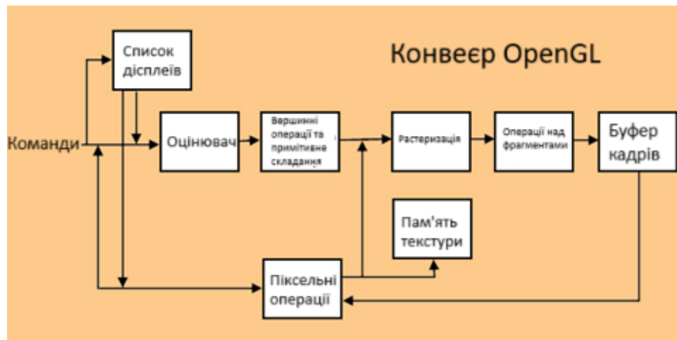
Рисунок 1.10 – Архітектура обчислювального пайплайну в OpenGL
