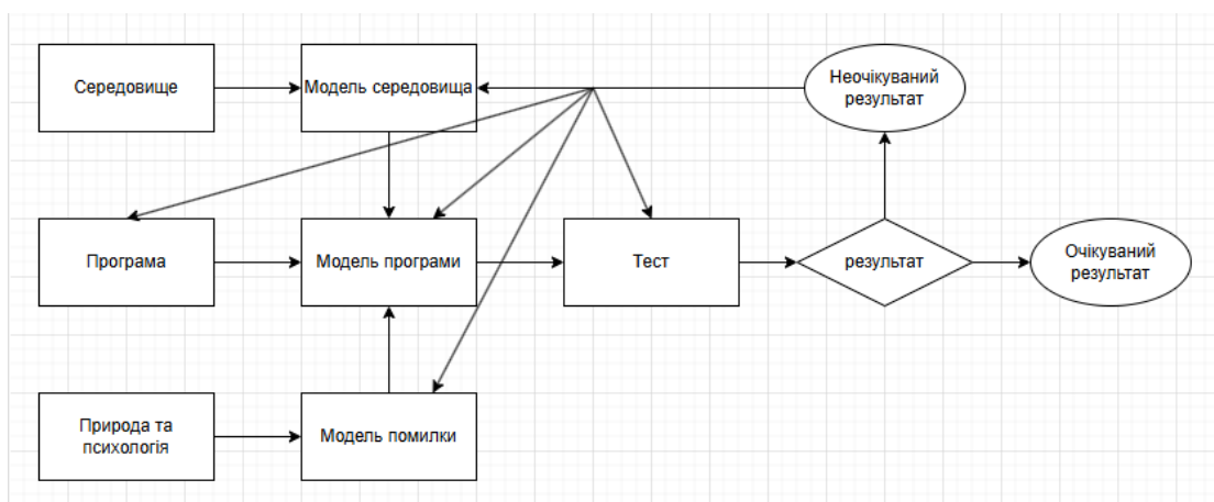
Рисунок 2.1 – Загальна модель тестування Android-застосунку
