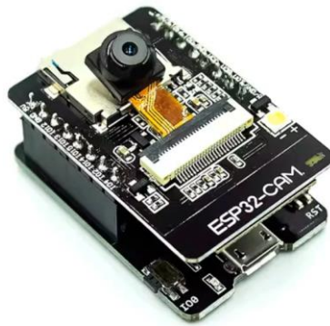
Рисунок 2.7 – Загальний вид модуля ESP32-Cam [17]
