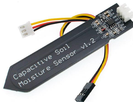
Рисунок 2.3 – Загальний вид ємнісного датчика вологості ґрунту від DFRobot
