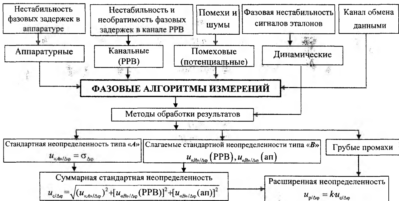
Рис. 5. Структура погрешностей и неопределенностей измерений для ФМС
