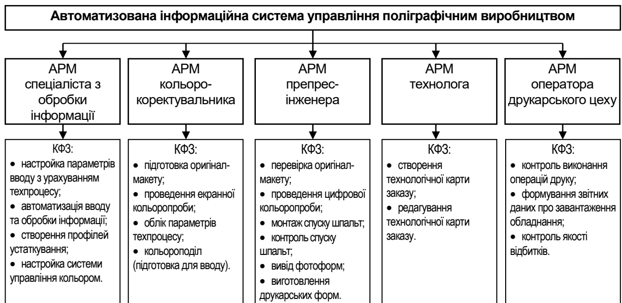
Рисунок 1.1 – Структурна схема виробничих відділів АІСУПВ
