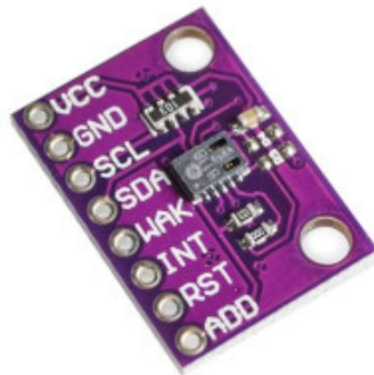
Рисунок 2.7 – Модуль датчика якості повітря CCS811 [16]
