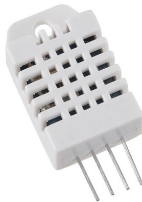
Рисунок 2.5 – Датчик температури і вологості DTH 22 [16]
