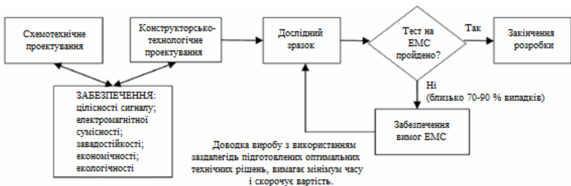
Рисунок 2 – Комплексний підхід під час проектування, що враховує вимоги ЕМС
