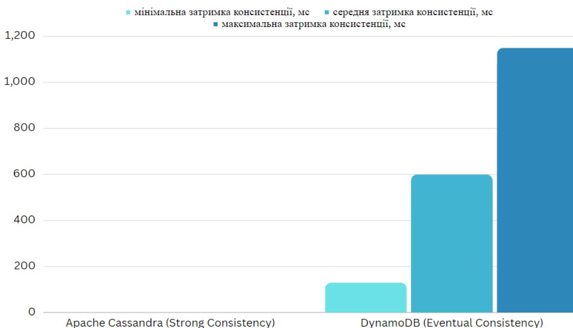
Рисунок 4.18 – Графік порівняння мінімального, середнього арифметичного та максимального часу затримки консистенції в базі даних Apache Cassandra (ACID на розподіленому рівні) та DynamoDB (BASE)
