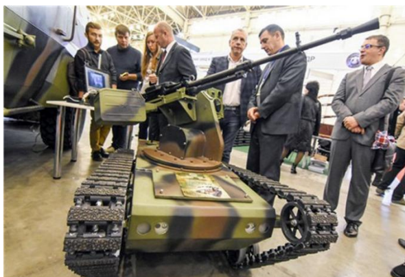
Рисунок 1.5 – Конструктивне виконання наземного роботизованого комплексу «Піранья»
