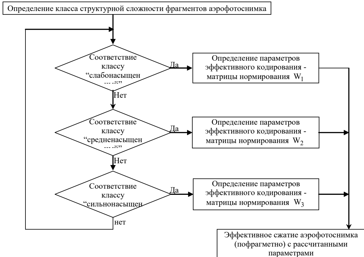
Рис. 2. Структурно-функциональная схема алгоритма определения параметров нормирования
