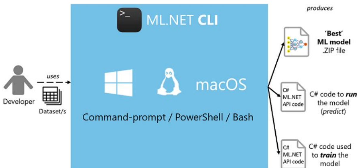
Рисунок 3.2 – Принцип роботи ML.NET CLI
