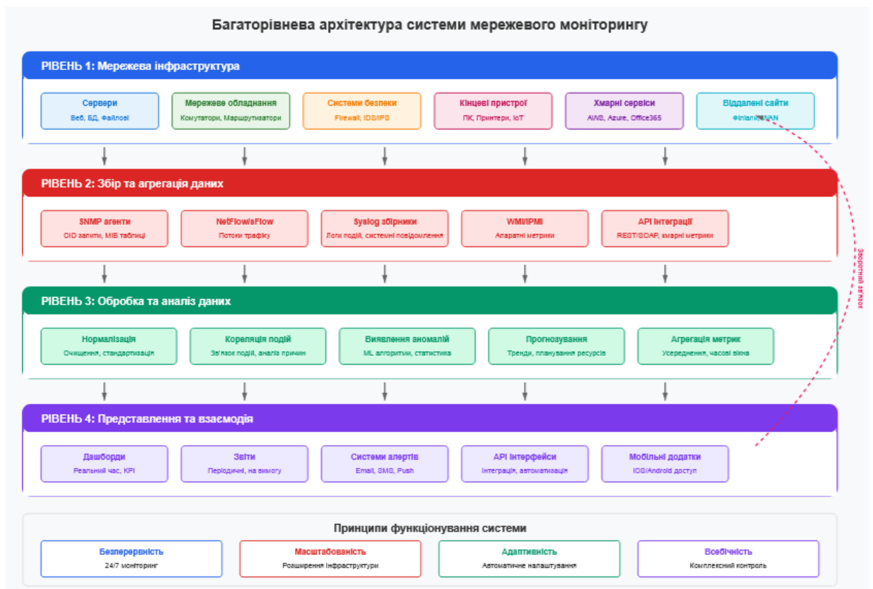
Рисунок 1.1 – Багаторівнева архітектура системи мережевого моніторингу
