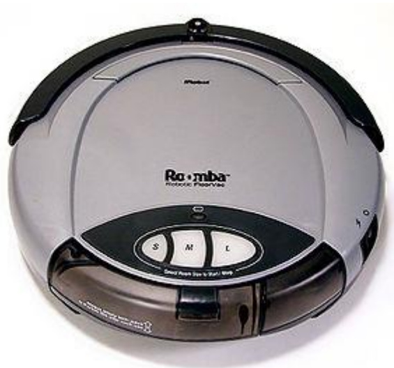
Рисунок 1.8 – Двох колісний робот-пилосос Roomba [11]
