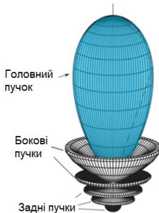
Рисунок 1.9 – Просторова діаграма випромінювання ультразвукового приймача ТСТ40-16R/Т
