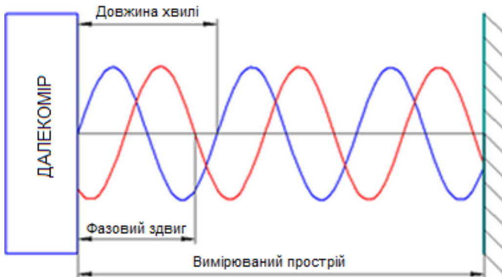
Рисунок 1.16 – Схема фазового зсуву у фазовому далекомірі
