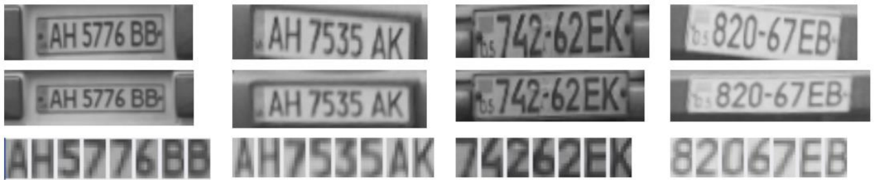
Рисунок 2.9 – Приклади роботи алгоритмів нормалізації зображення номера і сегментації символів
