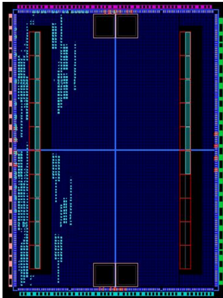
Рисунок 3.4 – Розведення топологічних елементів в ПЛІС
