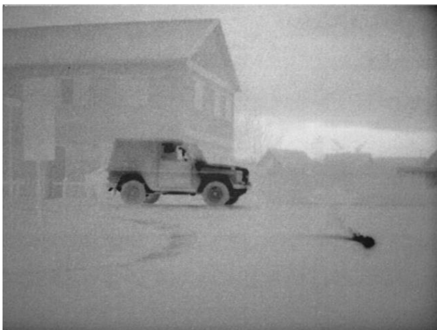
Рисунок 2.10 – Комплексоване зображення з телевізійного та тепловізійного каналу Приклад 2
