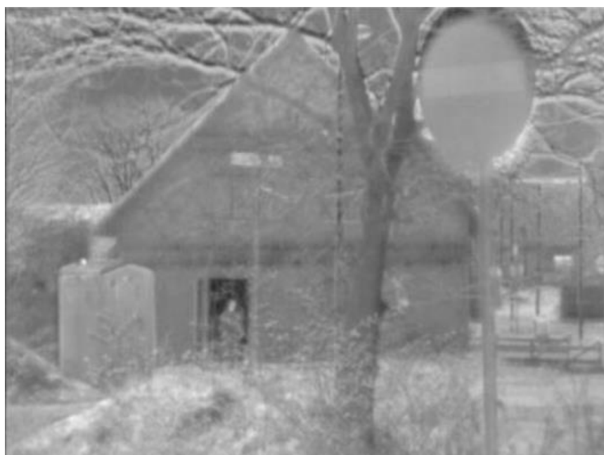
Рисунок 2.13 – Комплексоване зображення з телевізійного та тепловізійного каналу
