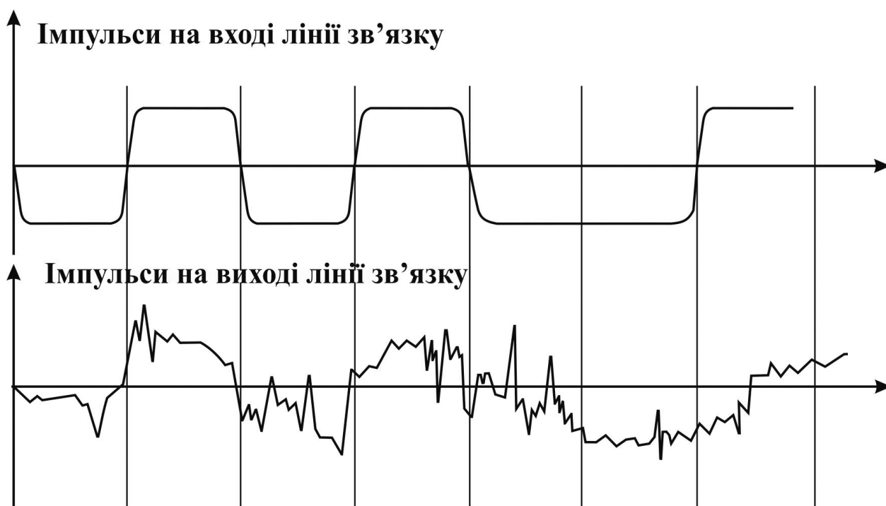
Рисунок 4.5 – Перекручування імпульсів у лінії зв'язку
