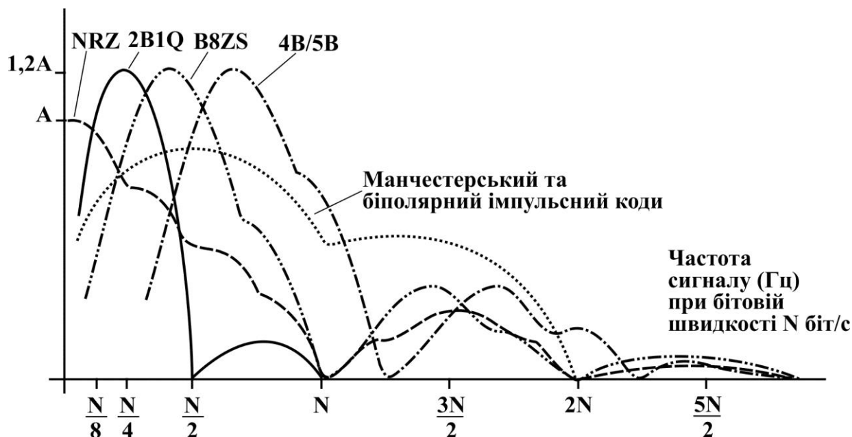
Рисунок 6.4 – Спектри потенційних і імпульсних кодів
