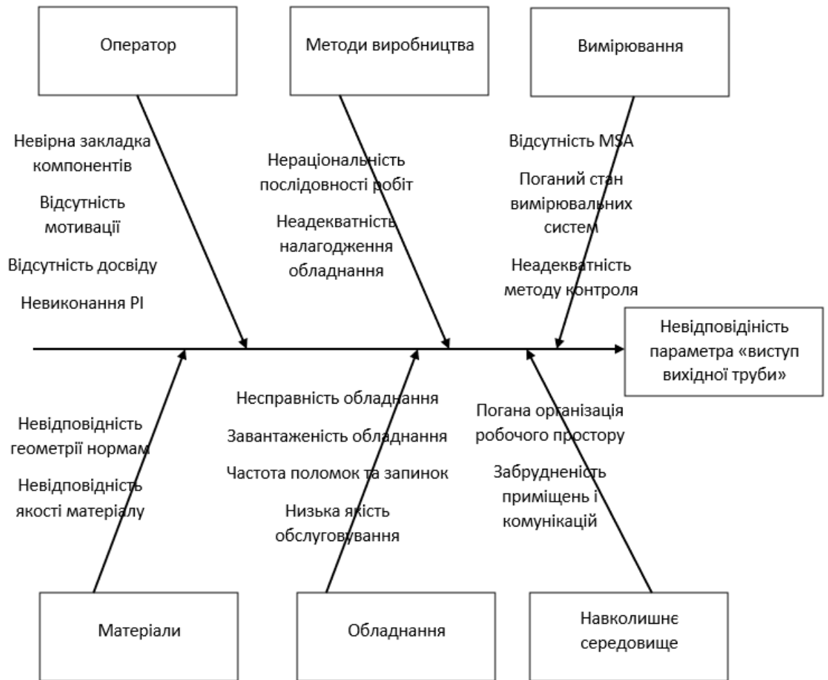
Рисунок 2.13 – Діаграма Ішікава проблеми «Можливі причини виникнення невідповідностей за параметром «виступання вихідної труби»»
