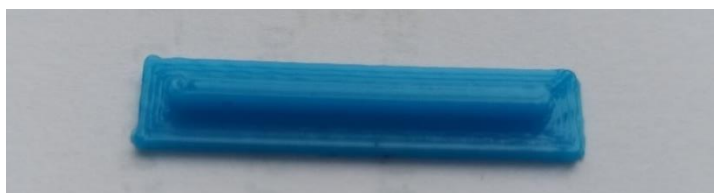
Рисунок 4.15 – Надрукований на 3D-принтері затвор
