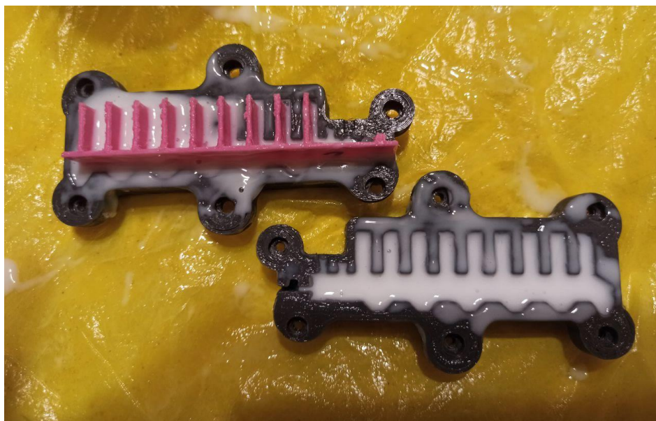
Рисунок 4.8 – Залитий силікон в праву прес-форму
