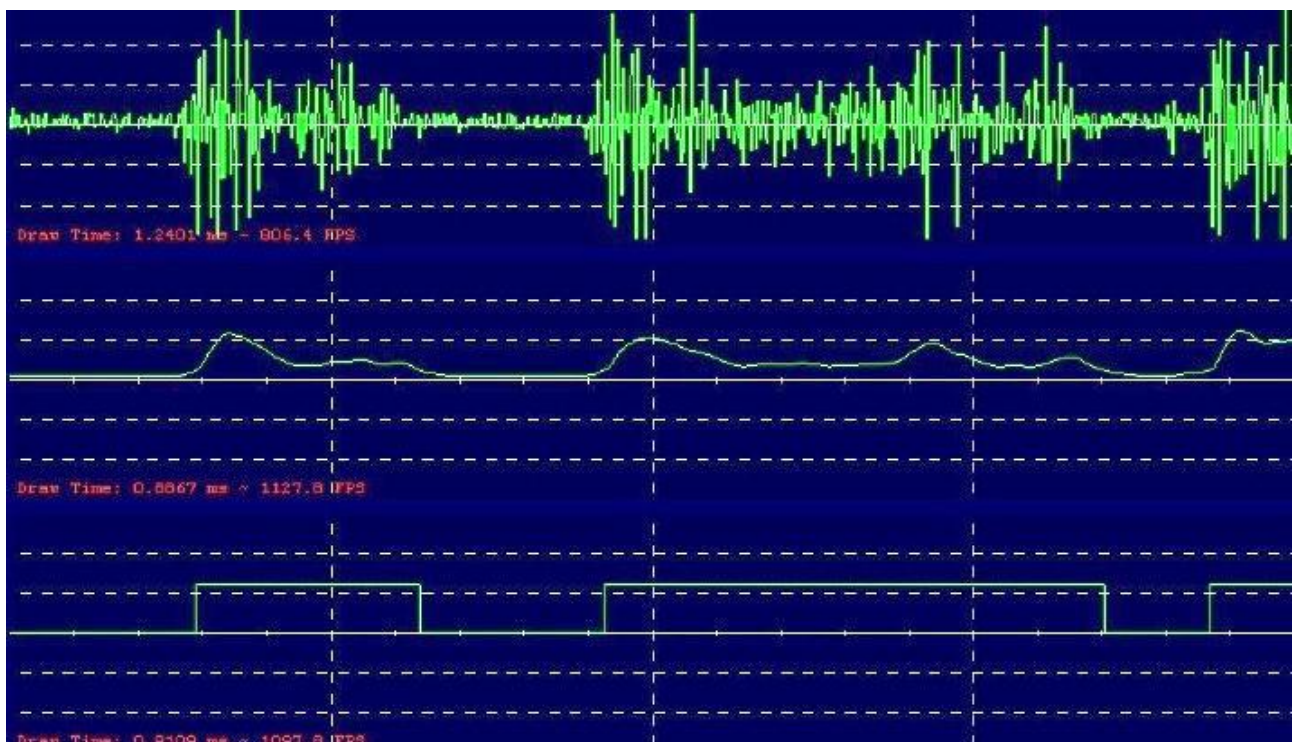
Рисунок 4.7 – Результати емуляції роботи модуля управління рухом біопротеза верхньої кінцівки
